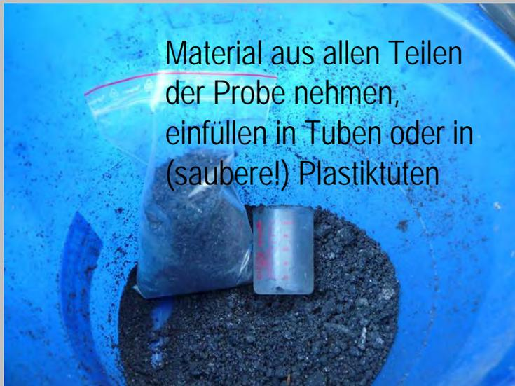
Material aus allen Teilen der Probe nehmen, einfüllen in Tuben oder in (saubere!) Plastiktüten
