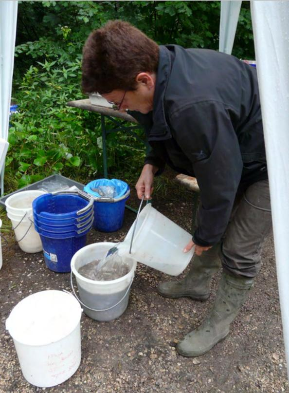
Die Probe wird in einen Eimer mit Literskala umgefüllt und mit Wasser versetzt (umrühren!!)
