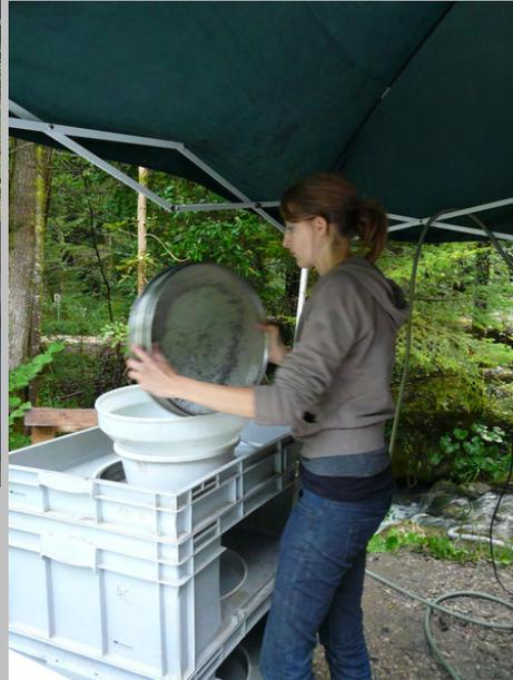
Sieb unten herausnehmen, in Umfülltrichter mit grossem Becken darunter stülpen (um 180 Grad drehen)
