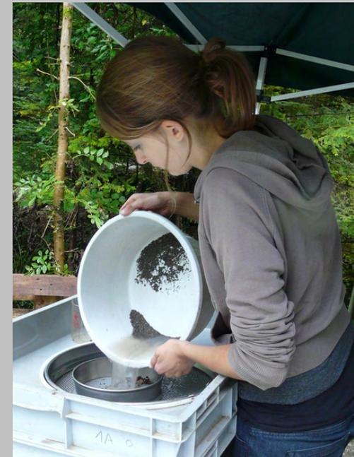
Material aus dem Becken in ein kleines Umfüllsieb (Maschenweite 0,125mm) spülen
