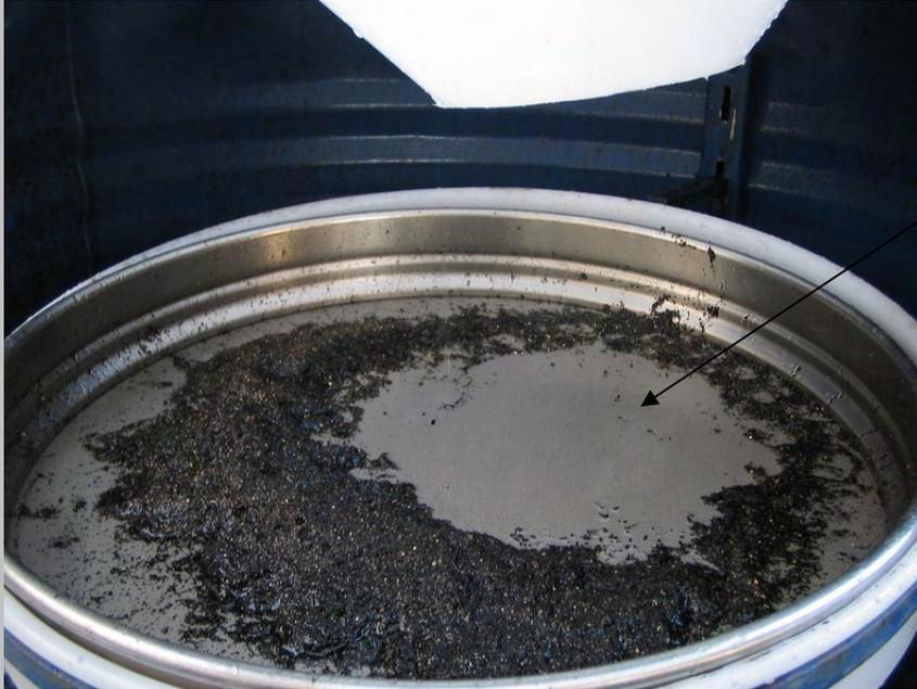
Das in den Sieben 4mm, 1mm und 0,35mm aufgefangene organische Material wird leicht durchgespült (schwacher Strahl!)
