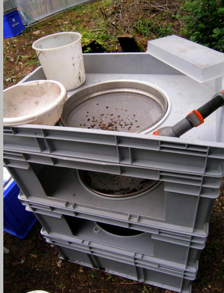
Schlammurm mit der Möglichkeit, 3 Siebe (Durchmesser 40cm) unterschiedlicher Maschenweiten einzusetzen, zuunterst Schlammsammler
