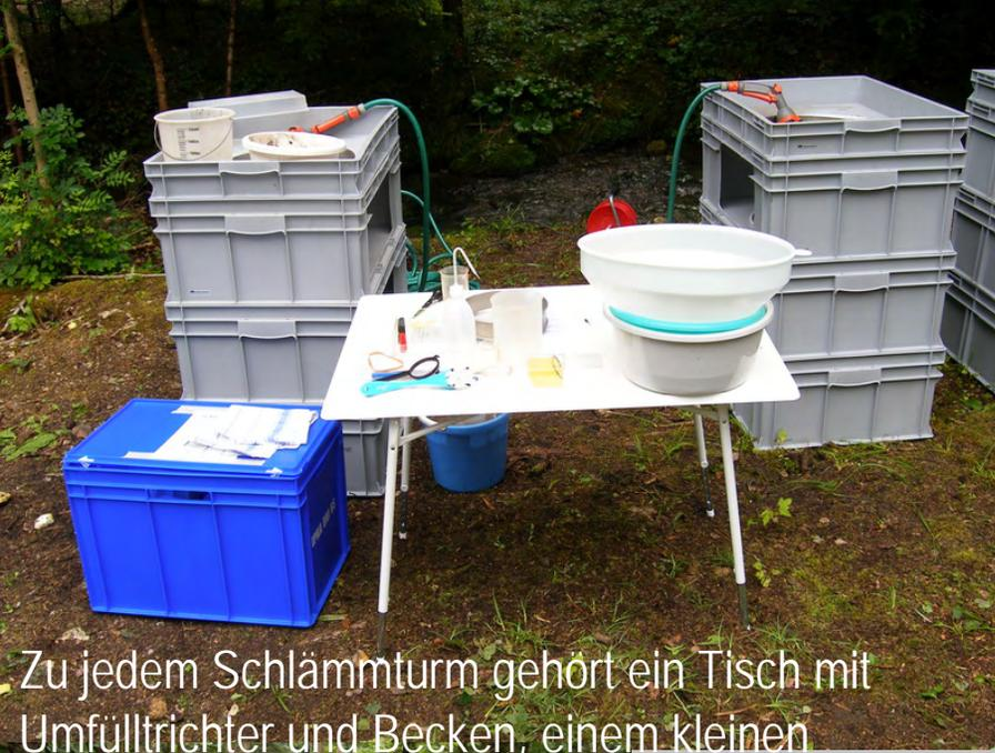
Zu jedem Schlammurm gehört ein Tisch mit Umfülltrichter und Becken, einem kleinen Umfüllsieb, Schreibmaterial, Plastikkarten usw.
